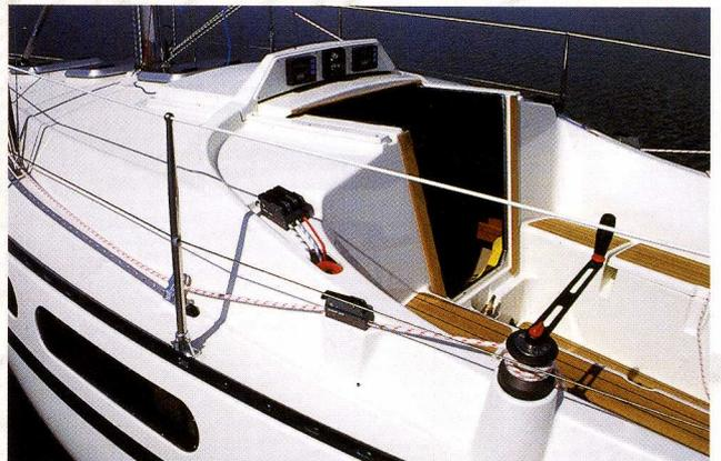
Ein wichtiger Sicherheitsfaktor: Bei der HAI-760 laufen alle Fallen durch einzelne, einlamierte Nirorohre ins Cockpit und werden in den Fallenkästen verstaut.
