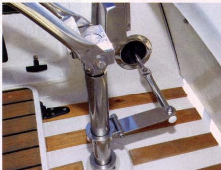
**Mechanisch.** Der Innensteuerstand muss über ein Gestänge zugeschaltet werden
