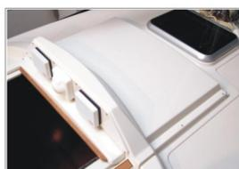
Schiebeluggarage mit Instrumentenkonsole, Instrumentenblende, 2 Außenblenden und 2 Teak Innenblenden zur Nachrüstung älterer HAle. (ohne Instrumente).
