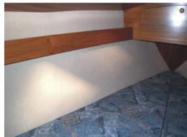
2 Teak Seitenablagen im Vorschiff - über die gesamte Seitenlänge des Vorschiffes. Fertig lackiert, Boden in Fronten eingeleimt, mit Befestigungsmaterial
