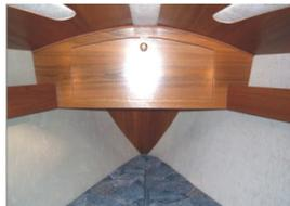
Teak Hängeschrank im Vorschiff, fertig lackiert, Klappe und Schließung montiert, mit Befestigungsmaterial
