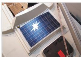
Solaranlage für Schiebeluggarage Hai-760 48 WP, incl. Regler für Blei/Säure- oder Gelbatterien. Wahlweise mit GFK Einlaminiert.
