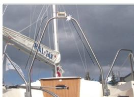
Jüt-Mastauflage aus Niro, mit Diabolorolle zum Verschieben des Mastes und zum sicheren Trailertransport.
