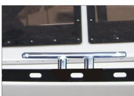
Springklampen aus Niro, Länge 200mm mit angeschweißten Gewindestangen, Scheiben und Muttern. Wird durch Fußreling und Rumpf/ Decksflansch geschraubt.
