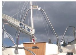
Jüt-Mastauflage aus Niro, mit Diabolorolle zum Verschieben des Mastes und zum sicheren Trailertransport.
