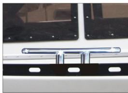
Springklampen aus Niro, Länge 200mm mit angeschweißten Gewindestangen, Scheiben und Muttern. Wird durch Fußreling und Rumpf/ Decksflansch geschraubt.
